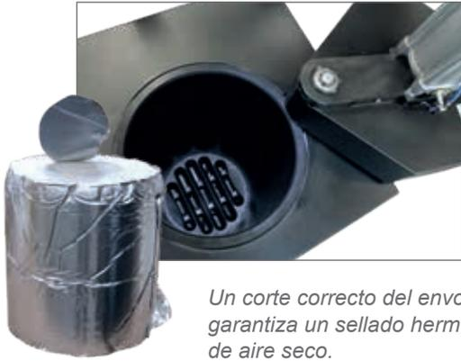
Un corte correcto del envoltorio que cubre el taco de PUR garantiza un sellado hermético del depósito sin necesidad de aire seco.
