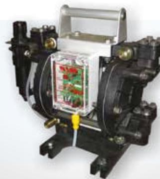
Die Kolbenpumpe EPP-6 von Valco Melton ist durch eine kontaktlose Schwachstromelektronik automatisch umgekehrbar. Die EVP-6 ist mit einer elektronischen Umkehrsteuerung äußerst zuverlässig und nicht von den typischen Verschleißmerkmalen mechanischer Geräte betroffen. Aufgrund ihres Designs kann die Pumpe nicht blockieren. Bei Anwendungen mit unterbrochenem Förderstrom stoppt die Pumpe und startet bei Anforderung des Systems wieder sofort.
