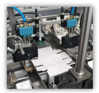
Die MKF Auftragskopfserie bietet zwei Moduloptionen: Bead oder Zero Cavity. Bead-Mini-Module arbeiten mit geraden, 90° und kugelförmigen Standarddüsen. Zero-Cavity-Minimodule ermöglichen einen extrem schnellen und genauen Leimauftrag mit jedem Klebstofftyp.
