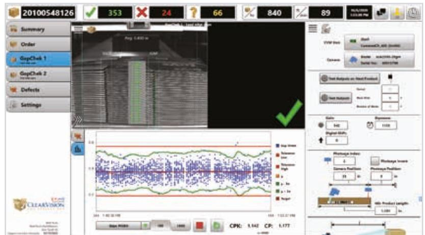
Wenn das optionale BundleChek-Bündelauswurfssystem sehr nahe am GapChek-System montiert ist, kann GapChek die Bündel direkt auswerfen. Andernfalls werden die Bündel mit fehlerhaften Lücken für die spätere Ausschleusung durch einen optionalen BundleChek markiert.
