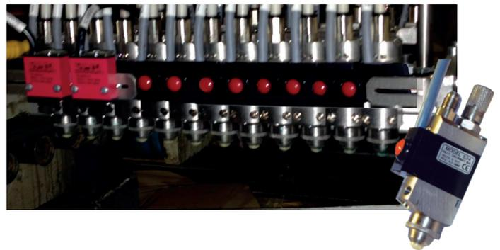
Valco Melton propose un système de collage composé d'une série de valves sans contact qui appliquent des points de colle. Facile à intégrer dans la machine, cette solution évite d'avoir à relancer le produit pour la deuxième application de collage ou d'avoir un accessoire pour faire pivoter le carton à 90° sur votre plieuse-colleuse.
