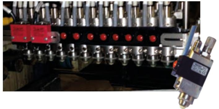
Valco Melton bietet ein System aus kontaktlosen Auftragsköpfen an, das Kalteimpunkte aufträgt. Das System ist einfach in die Maschine integrierbar. Es erspart den Prozess, das Produkt für einen zweiten Leimauftrag erneut durch die Maschine laufen zu lassen oder aber einen 90 Grad Umlenker an der Faltschachtel-Klebemaschine anzubringen.
