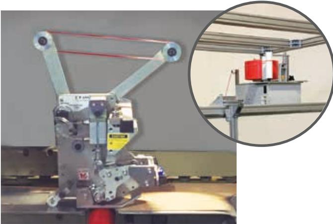
Sowohl der Auftragskopf als auch der Abroller sind in der Maschine integriert.
