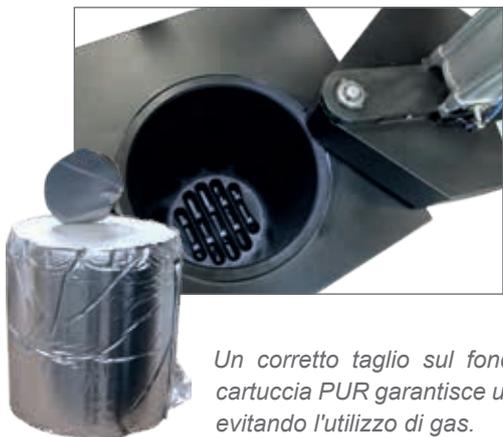
Un corretto taglio sul fondo della lamina che ricopre la cartuccia PUR garantisce una tenuta ermetica del serbatoio evitando l'utilizzo di gas.
