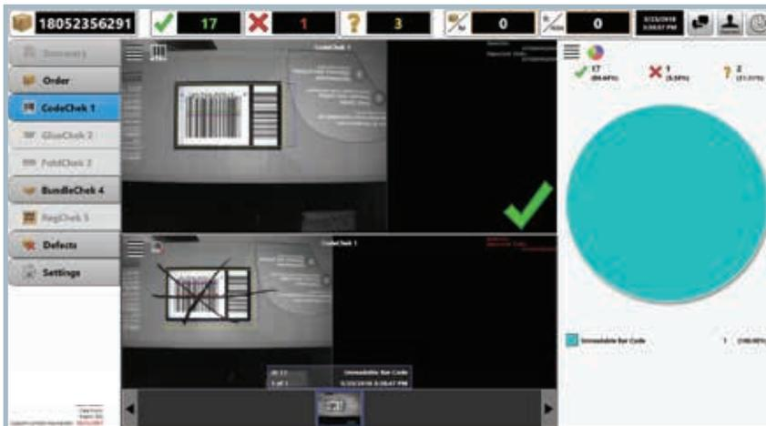
Es kann Barcodes mit hoher Geschwindigkeit von bis zu 30 Kartons pro Sekunde und in Bereichen von bis zu 23 x 23 cm lesen. Je nach Anforderung kann die Kamera von unten nach oben oder von oben nach unten montiert werden.
