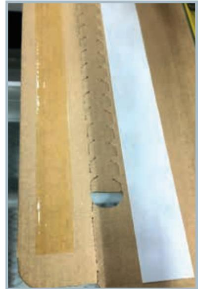
Das SealTak-System gibt druckempfindlichen Heißschmelzkleber auf das Substrat ab und legt dann eine Silikon-Trennfolie mit Versatz über den Klebstoff, um abziehbare und versiegelbare Produkte herzustellen.
