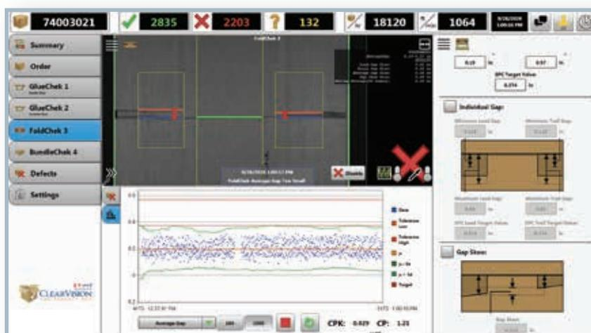
Die FoldChek-Statistik zeigt die Falztrends an und ermöglicht so die Anpassung der Maschine, um die gewünschte Spaltbreite zu erreichen.
