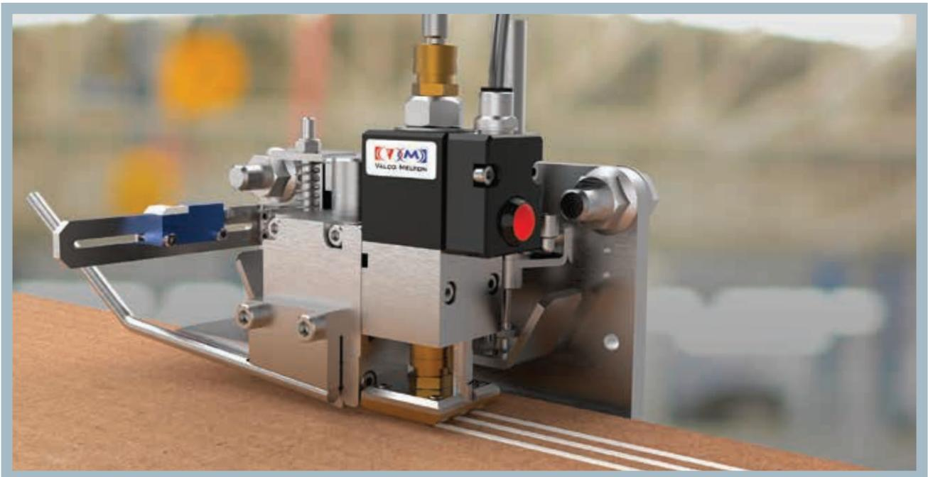
**Der BoardRunner kann leicht von oben nach unten/von unten nach oben für Innen- oder Außenverleimung umgebaut werden.**
