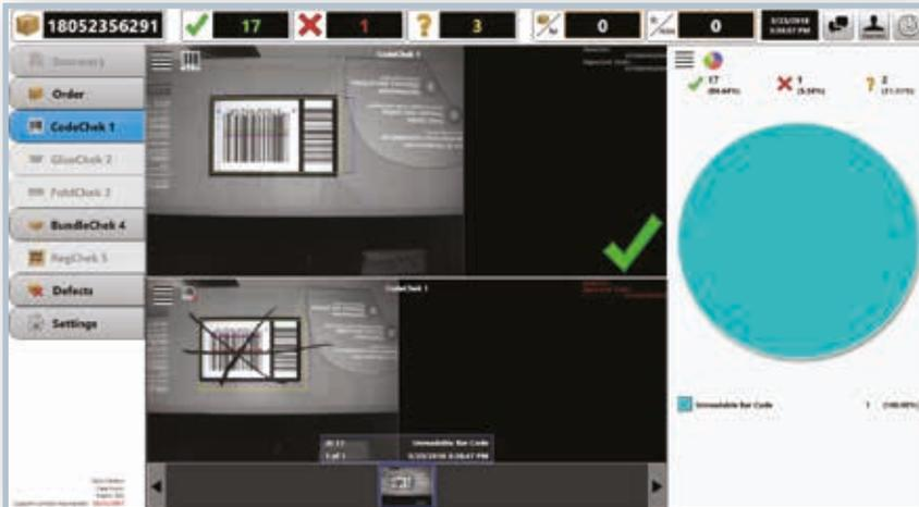
Capaz de leer códigos de barras a alta velocidad, hasta 30 cajas/segundo, y en áreas de hasta 23 x 23 cm. Se adapta a sus requisitos de producción con la posibilidad de montar la cámara para lectura desde arriba o desde abajo.
