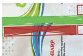
过度加热导致封口变形
