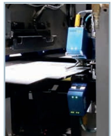
Instalación doble de cámaras para una inspección de la parte trasera
