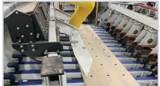
Se monta sobre la cinta transportadora existente en máquinas de troquelado y plegadoras-encoladoras
