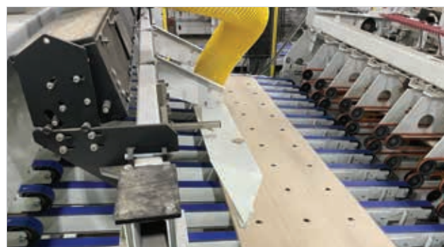
Se monte sur le convoyeur existant sur les découpeuses et les plieuses-colleuses flexographiques
