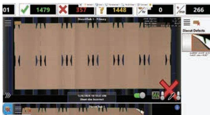
Interfaccia ClearVision intuitiva: funzionamento semplice con mappatura visiva dei difetti
