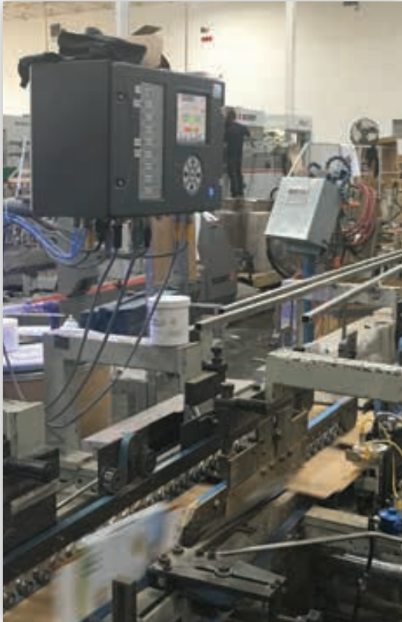
MCP-8 Leimsystem-Mustersteuerung mit Inspektionsfunktionen
