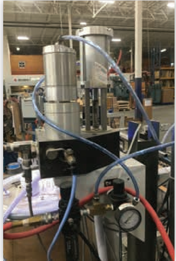
Die PFRM-5 Optin bietet eine einteilige Klebstoffquelle für eine einfache Installation und einen kostengünstigen Preis. Einschließlich Kolbenpumpe, Inline-Filter.
