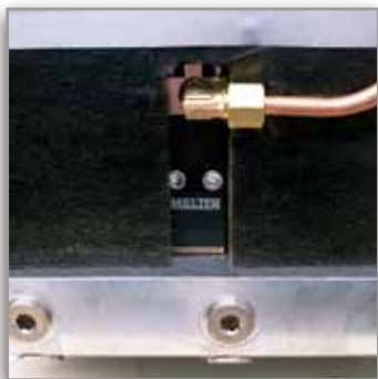
Vanne de décharge de pression pour une maintenance et un entretien en toute sécurité
